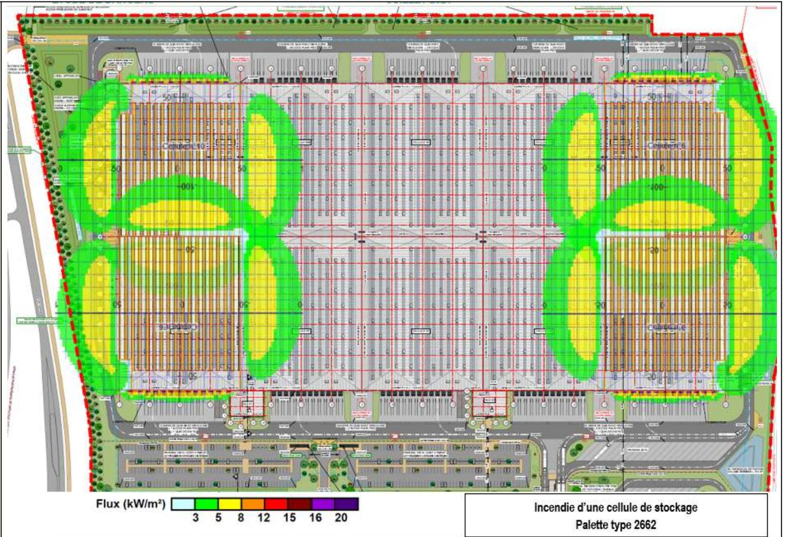
III. Les parois externes des cellules de l'entrepôt (ou les éléments de structure dans le cas d'un entrepôt ouvert) sont suffisamment éloignées des stockages extérieurs et des zones de stationnement susceptibles de favoriser la naissance d'un incendie pouvant se propager à l'entrepôt. « La distance entre les parois externes des cellules de l'entrepôt et les stockages extérieurs susceptibles de favoriser la naissance d'un incendie n'est pas inférieure à 10 mètres.
