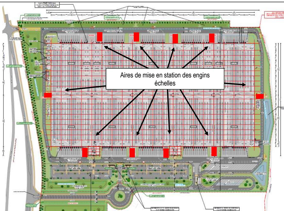
Les aires de mise en station des échelles seront réalisées en voirie lourde : résistance à la force portante calculée pour un véhicule de 320 kN avec un maximum de 130 kN par essieu, ceux-ci étant distants de 3,6 m au minimum, et présentant une résistance minimale au poinçonnement de 88 N/cm<sup>2</sup>.
