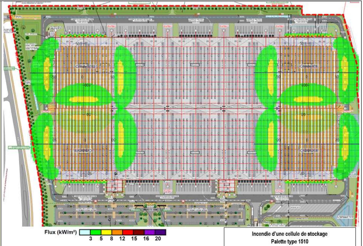
(seuil des effets thermiques de 5 kW/m<sup>2</sup>) restent à l'intérieur du site au moyen, si nécessaire, de la mise en place d'un dispositif séparatif E120.
